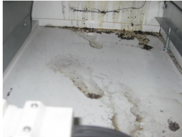
Kuva 34. Koneen käydessä tiivisteliimat ja koneen sisälle päässyt pöly ovat sotkeneet koneen sisäpinnat.
